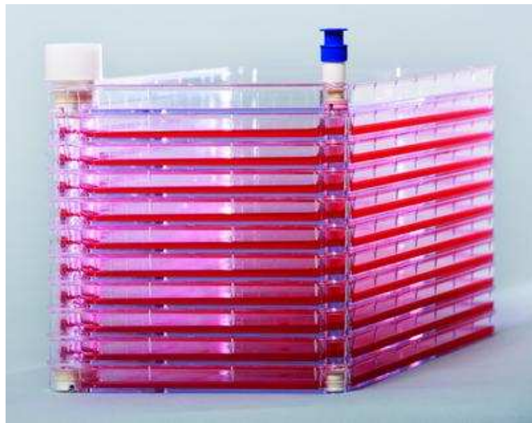
Figura 3-1. Cell factory de 10 andares. Fonte: Thermo Scientific website.
