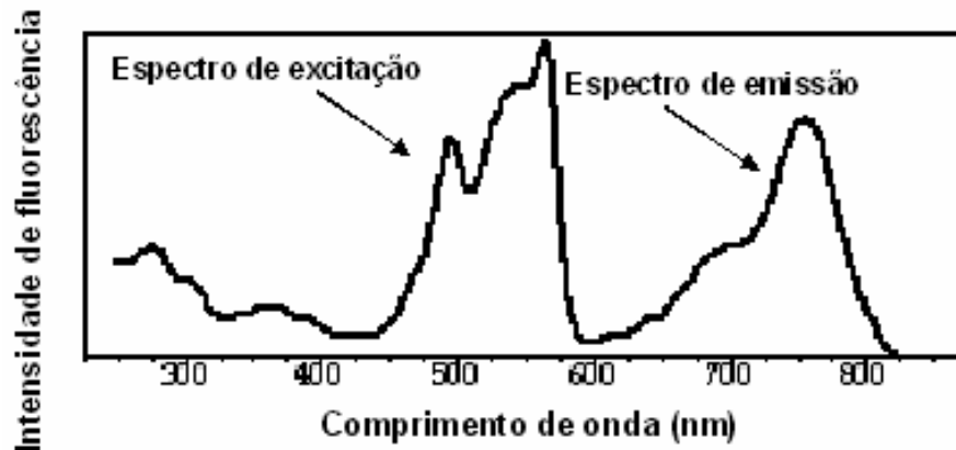
Figura 1.13: Espectro de excitação e emissão do fluorocromo R-PECy7. Fonte: Adaptado do site http://www.drmr.com/abcon/C7Paspec.html .
